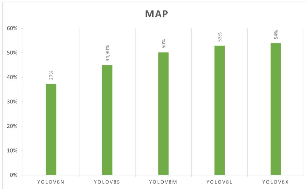
Abbildung 3.8: mAP Vergleich der YOLOv8 Modelle
