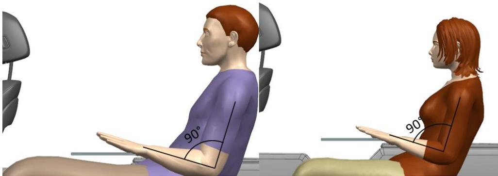
Ideale Arbeitsposition für 95M und 5F am Beispiel eines Mittelkonsolenklapptischs
