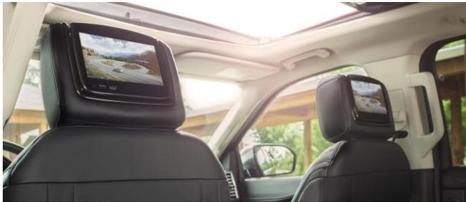
Abbildung 2-5: Kopfstützenmonitor
