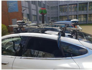
Abbildung 2.7: Dachaufbau mit den Sensoren
