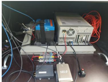
Abbildung 2.8: Der Computer, der Akku und die Sensoren im Kofferraum
