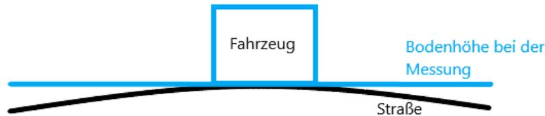
Abbildung 4.5: Skizze zur Erklärung des Offsetwerts. Die schwarze Linie ist die Straße, die blaue der Boden der Messung
