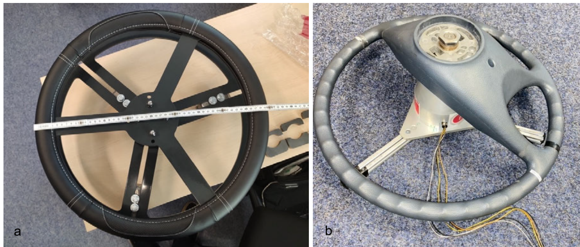
Abb. 7: a) neues Messlenkrad der GTÜ, mit Genehmigung der GTÜ und b) altes Messlenkrad, eigene Darstellung
