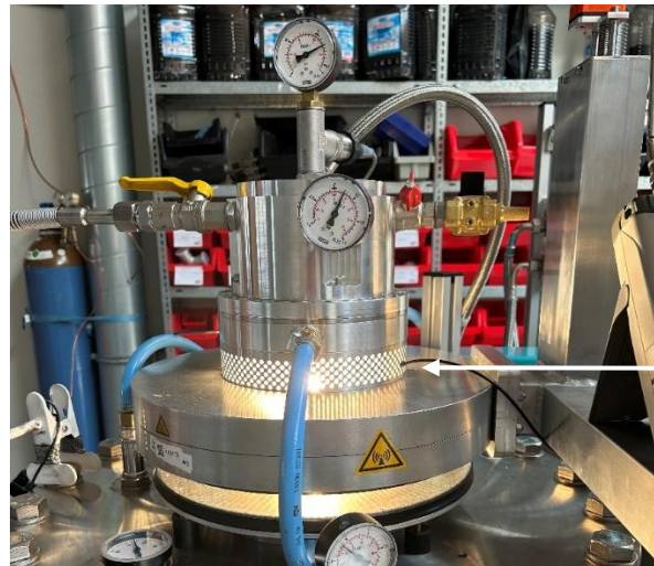
Abbildung 23: Position des Sensors der optischen Emissionsspektroskopie (eigene Aufnahme)
