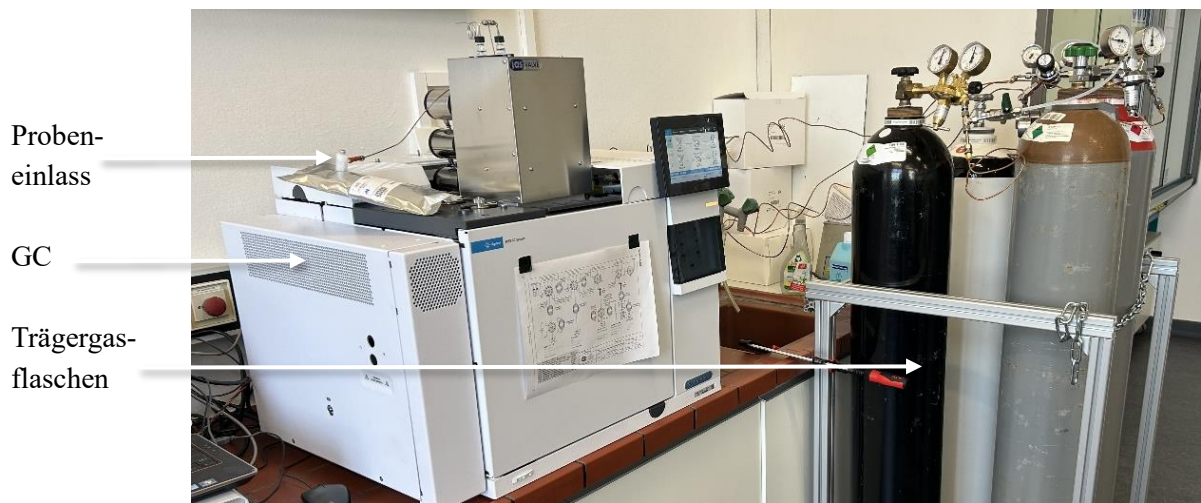
Abbildung 13: Messung des Produktgases am GC in Hamburg (eigene Aufnahme)
