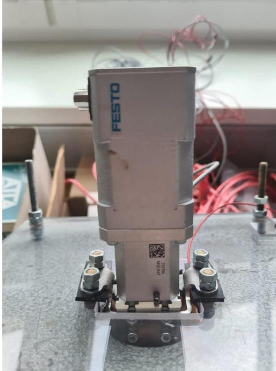
*Abbildung 31 - Antrieb mit Nutzensteinbefestigung*
