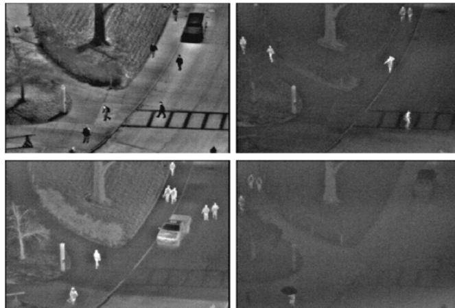
Abbildung 2.1: Wärmebild von der gleichen Szenerie unter unterschiedlichen Bedingungen [14]
