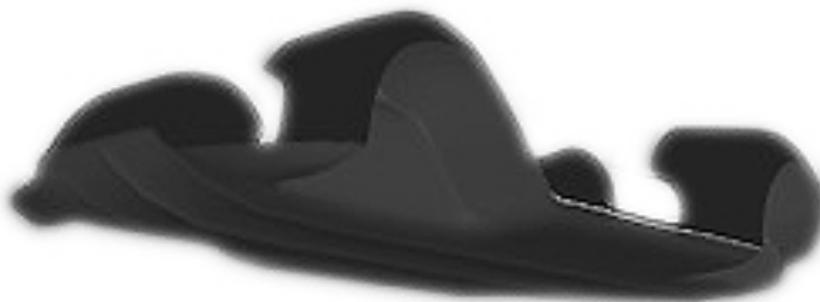
Abbildung 27 Rumpf des Amphibienfahrzeuges
