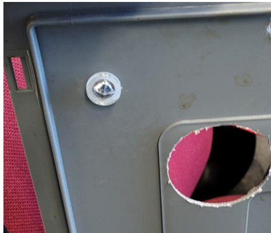
Abbildung 4.4: Bereits im Deckel eingebauter Füllstandssensor
