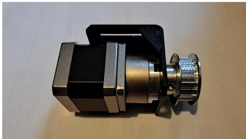
Abbildung 17: Schrittmotor NEMA 17GM mit Getriebe und Zahnscheibe
