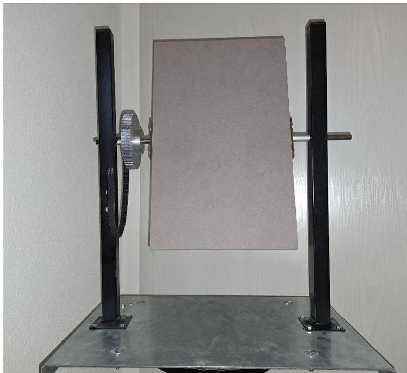
Abbildung 16: Modulträger auf Grundplatte mit Zahnriemenscheibe
