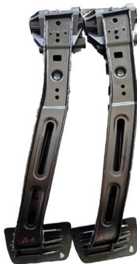
*Abbildung 31: Ergebnis Teile mit Abdeckung während des Lötens nach der Lackierung*
