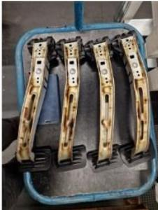
Abbildung : Pedale nach dem Löten mit sandgestrahlte Unter- und Oberteil
