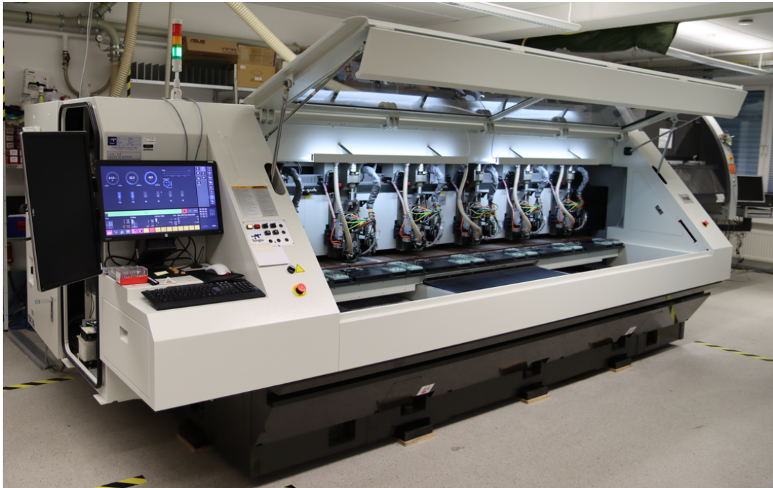
Abbildung 3.1: CNC Leiterplattenbohrmaschine mit sechs Bohrstationen. Modell SD-612 der Firma Tongtai
