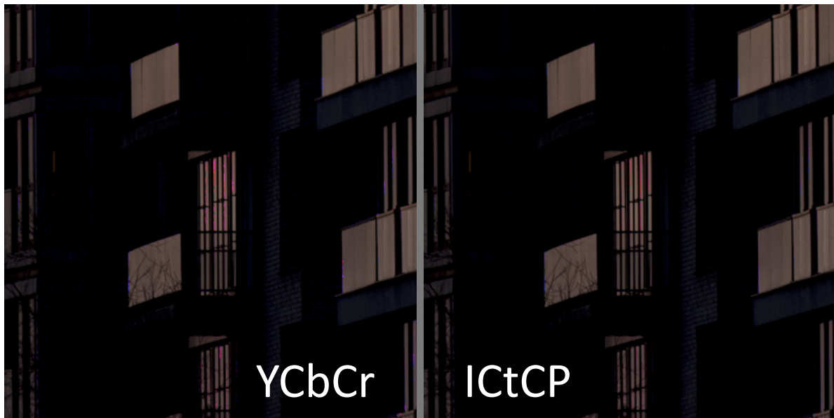
Abbildung 7.8: Artefakte nach Farbunterabtastung und Farbvolumen-Clipping
