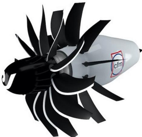
**Bild 8.2** Open-Rotor-Triebwerk (Airliners.de 2023a)
