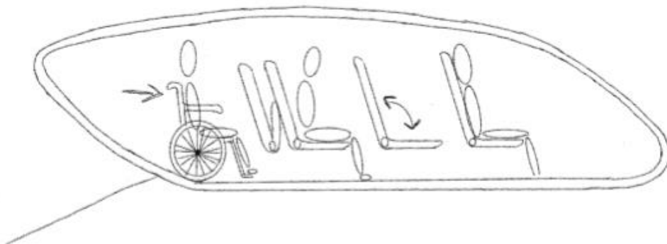
Abbildung 34 Platzierung einer Rollstuhlfahrenden Person in der Kabine des eSIMJT (Eigene Darstellung)
