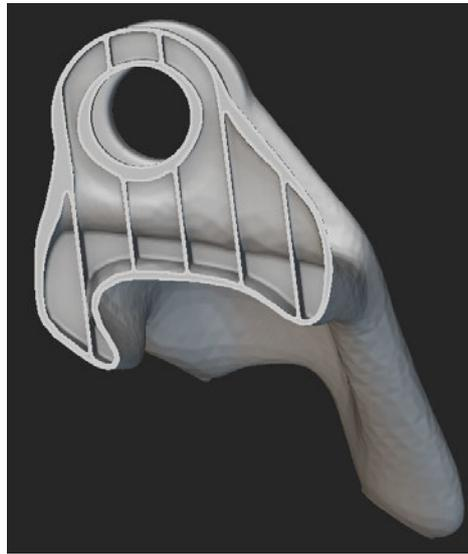
Abbildung 32: Schnittdarstellung feldoptimiertes Bauteil
