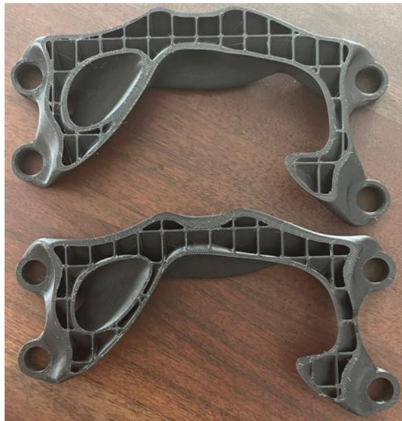
Abbildung 100: Schnitt Demonstrator Lattice (Oben) + Feldoptimierung (Unten)
