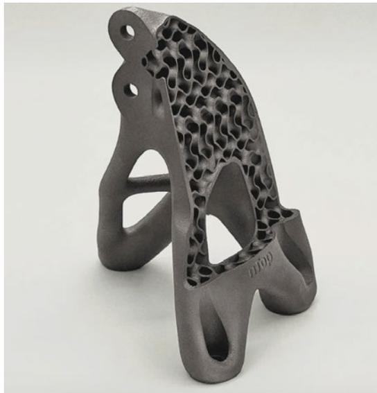
Abbildung 1: Infill Lattice-Struktur Beispiel von ntop [1]
