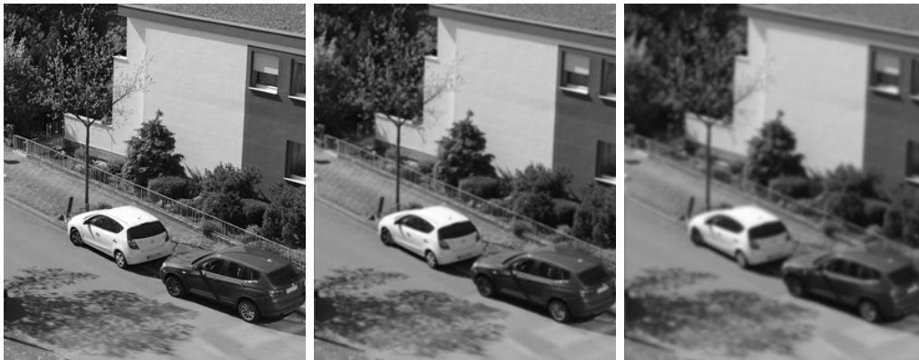
Abbildung 2.2: Glättung eines Bildes mit einem Gaussfilter. Links: Original, Mitte: Ergebnis 3x3 Filterkernel, Rechts: Ergebnis 7x7 Filterkernel
