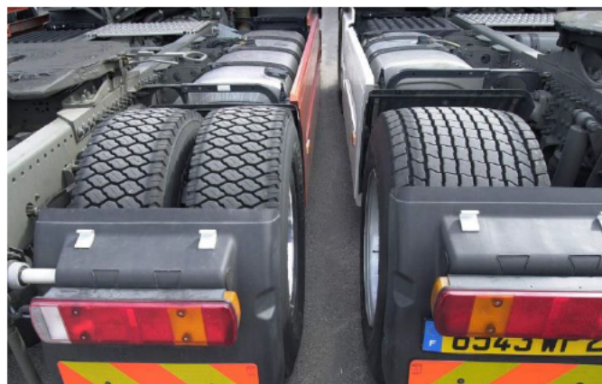
Abbildung 6.2: Vergleich Zwillingsbereifung - Super-Single [23]
