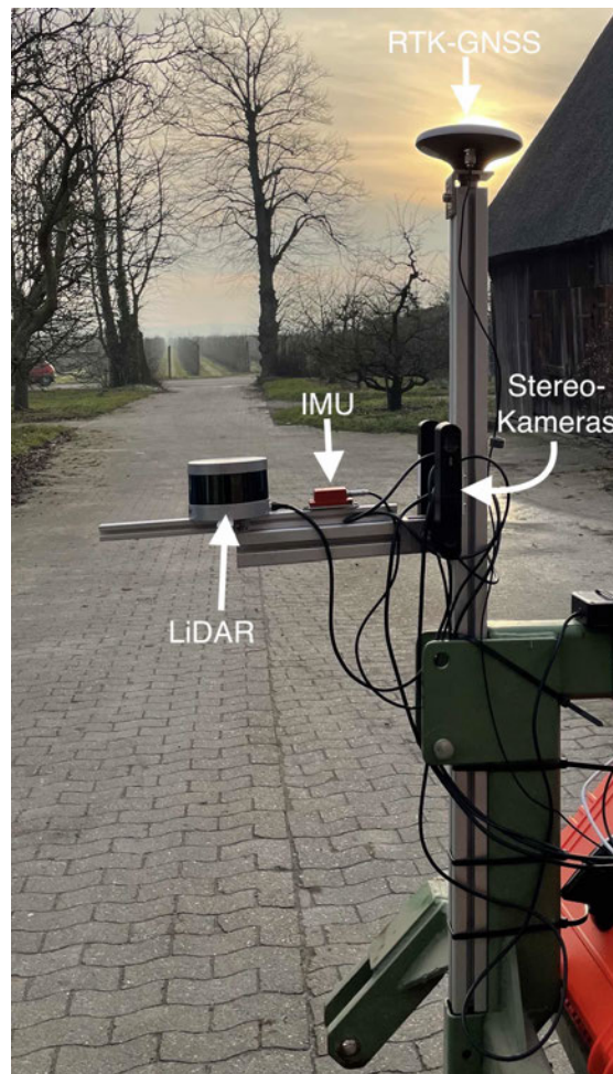
Abbildung 5.1: Sensoraufbau, befestigt an einem Anbaurahmen, der an beliebigen Traktoren aufgenommen werden kann. Horizontale Ausrichtung des LiDAR-Sensors.
