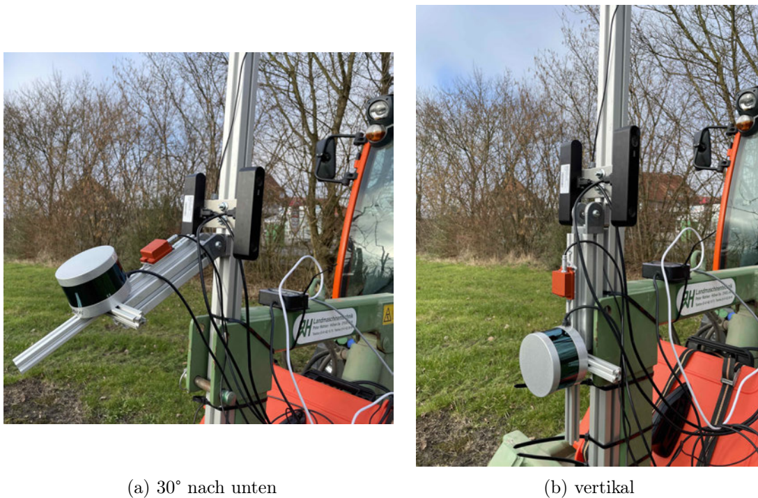
Abbildung 5.2: Sensoraufbau im Feld mit verschiedenen Ausrichtungen des LiDAR-Sensors, befestigt an einem Traktor
