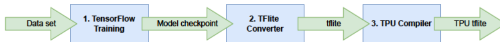
Abb. 3.3: Dreistufige Datenverarbeitungspipeline für das Generieren des gewünschten Modells mit Ein- und Ausgängen der jeweiligen Daten
