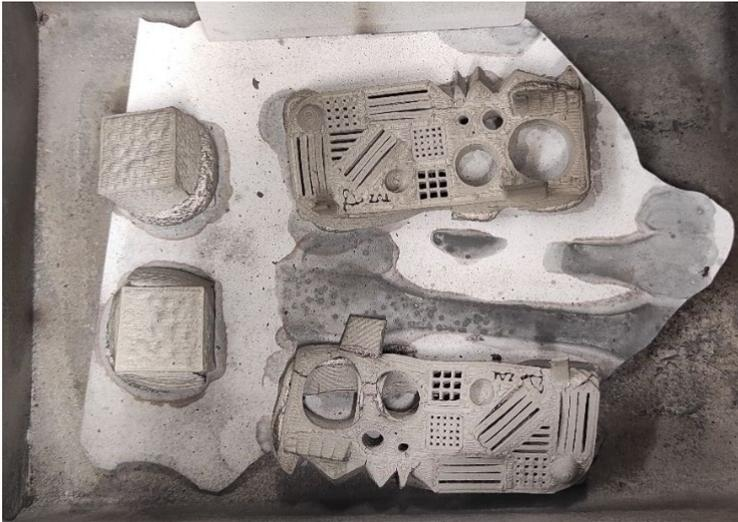
Abbildung 51: Begasungskasten direkt nach dem Sintervorgang, Handyaufnahme
