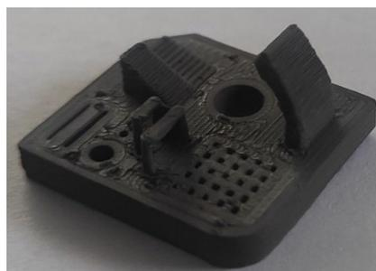
Abbildung 48: Proben für Druckparameteroptimierung: links Nummer 10, rechts Nummer 14
