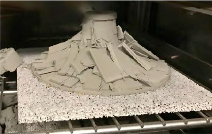
Abbildung 11: Über eine FFF Variante für Metallteile hergestelltes Bauteil nach erfolglosem Entbindern durch inhomogene Extraktion des Bindematerials (Kitzmantel & Wilfinger, 2017)
