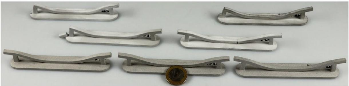
Abbildung 2: Bilder der sieben Exemplare der Halterung aus SS316L nach dem Sintern (Borujeni, 2022)
