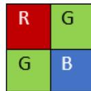
**RGB8planar:** Dieses Pixelformat definiert ein 8-Bit RGB (rot, grün, blau) planares Format. Planar bedeutet, dass jede Farbe einen separaten Block an kontinuierlichem Speicher hat. Für dieses Pixelformat werden drei aufeinander folgende kontinuierliche Speicherblöcke verwendet. Es ergeben sich 24-Bit pro Pixel. Es werden ein Rot-Wert, zwei Grün-Werte und ein Blau-Wert verwendet, um ein Pixel eines anderen hier verwendeten Formats zu errechnen.
