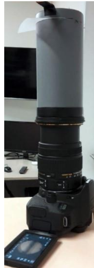
Abbildung 68: Die Canon-Kamera mit dem HAT-Rohr als Objektivverlängerung.
