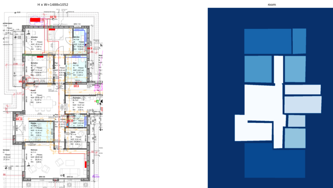
Abbildung 4.13: Besonders komplexer Grundrissplan mit Annotation aus dem PLAN4 Datensatz. Instanzen von Räumen werden durch unterschiedliche Farben repräsentiert. Name: PLAN-226
