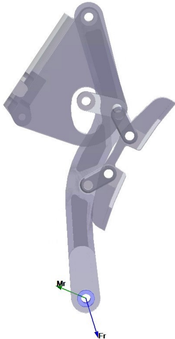
Abbildung A.3: Lagerreaktionskraft Lager E
