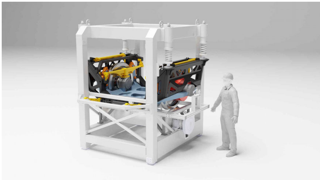
Abbildung 4.1: Darstellung des Fahrwerks des NGT HST im Prüfstand
