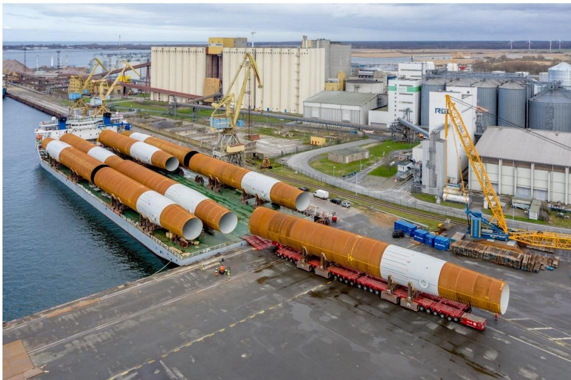
**Abbildung 1 Verladen von Monopiles auf Schwergutschiff [8]**
