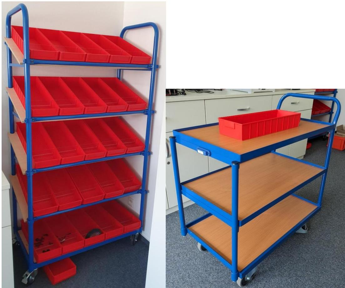
Abbildung 9: Bereitstellungseinheit (links) und Kommissionierwagen (rechts)
