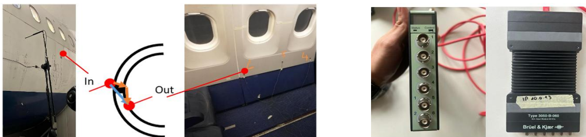
Abbildung 7: Beispielaufbau zur Unterscheidung von Luft- und Körperschall (links) sowie 6-Kanal-LAN-XI-Modul zur Datenerfassung (rechts)
