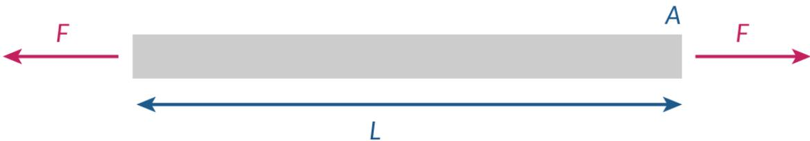
Abb. 2.4.: Krafteinwirkung auf einen Balken uniformen Querschnittes [8]
