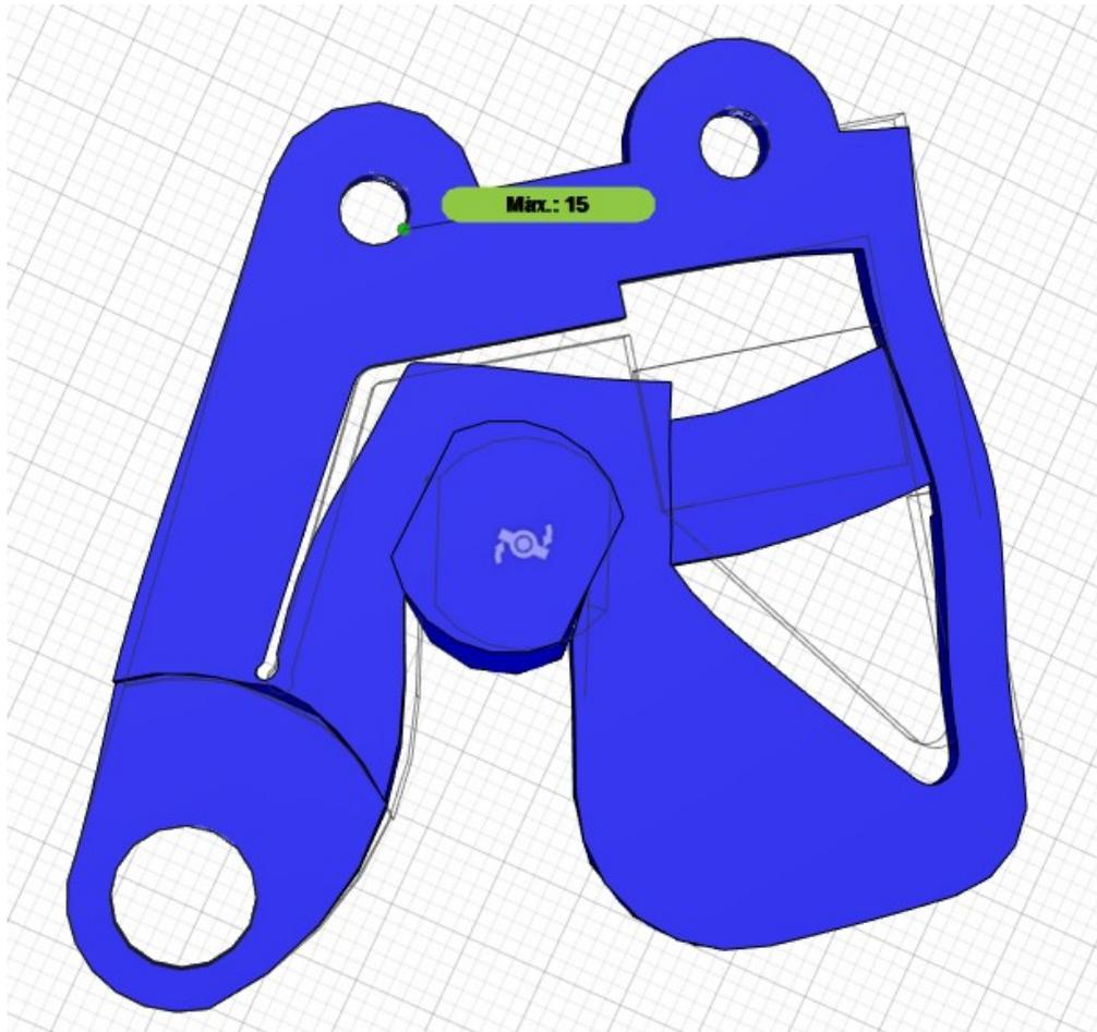
Abbildung 5.18: Simulation der Spannungsanalyse des Messaufnehmers V2 bei Einwirken von 1 Nm an der Hinterradachse
