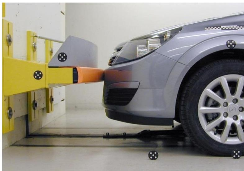
Abbildung 3-1 RCAR-Test - langsamer Frontcrash [B5]
