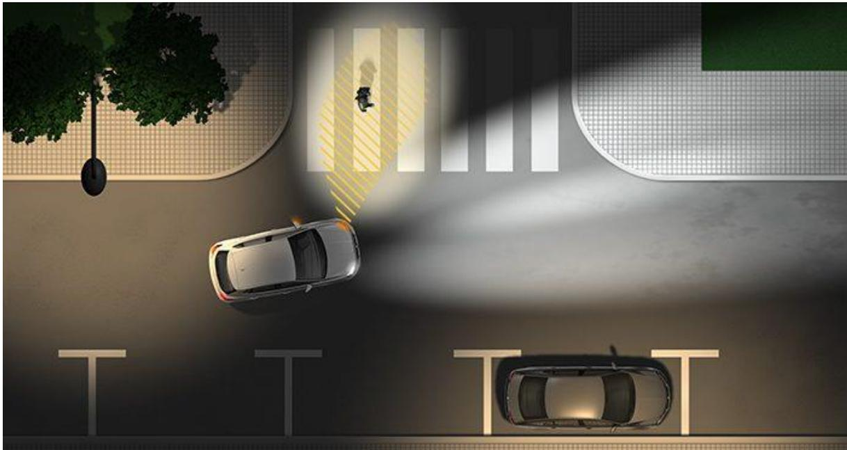
**Abbildung 12:** Funktionsweise des dynamischen Kurvenlichts [Seat 2021]
