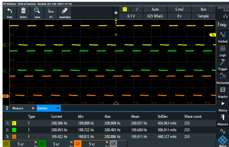
Abbildung 6.5: Tacho-Signale der drei Kanäle mit Messung und Statistik der Frequenzen bei 6000 rpm
