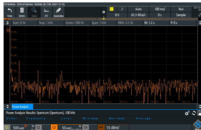
Abbildung 6.22: FFT Spektrum der Spannung auf der Versorgungsseite des Filters mit Oszilloskop und Power Rail Probe gemessen
