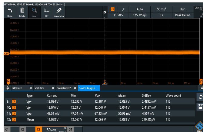
Abbildung 6.20: Messung der Spannung auf der Versorgungsseite des Filters mit Oszilloskop und Power Rail Probe
