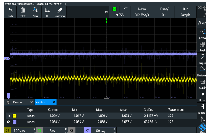
Abbildung 6.18: Messung der Spannungen auf der Versorgungsseite (C4, blau, oben) und auf der Lüfter Seite (C1, gelb, unten) des Filters mit Oszilloskop und Tastkopf
