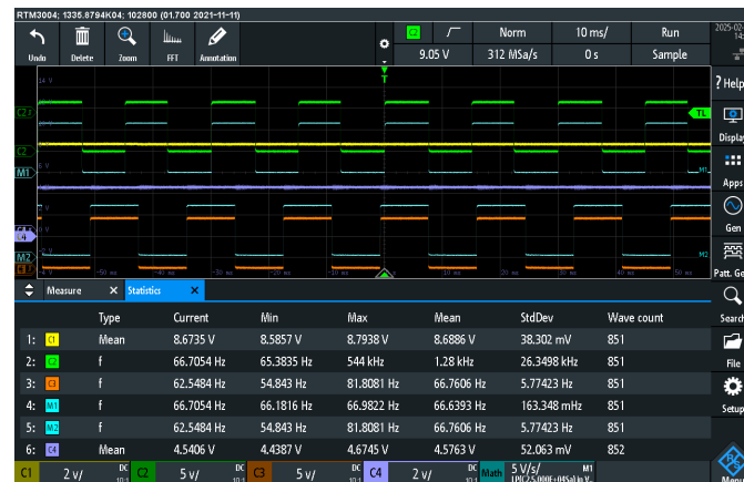
Abbildung 6.15: Vergleich der Drehzahlregelung des vorgegebenen und des alternativen Lüfters bei 2000 rpm: Die Tacho-Signale und Lüfterspannungen werden mit dem Oszilloskop gemessen und ausgewertet; C1: Spannung alternativer Lüfter, C2: Tacho-Signal alternativer Lüfter, C3: Tacho-Signal vorgegebener Lüfter, M1: Tacho-Signal alternativer Lüfter mit 50 kHz Tiefpass, M2: Tacho-Signal vorgegebener Lüfter mit 50 kHz Tiefpass, C4: Spannung vorgegebener Lüfter
