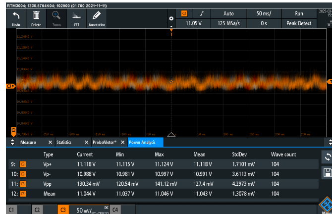
Abbildung 6.19: Messung der Spannung auf der Lüfter Seite des Filters mit Oszilloskop und Power Rail Probe
