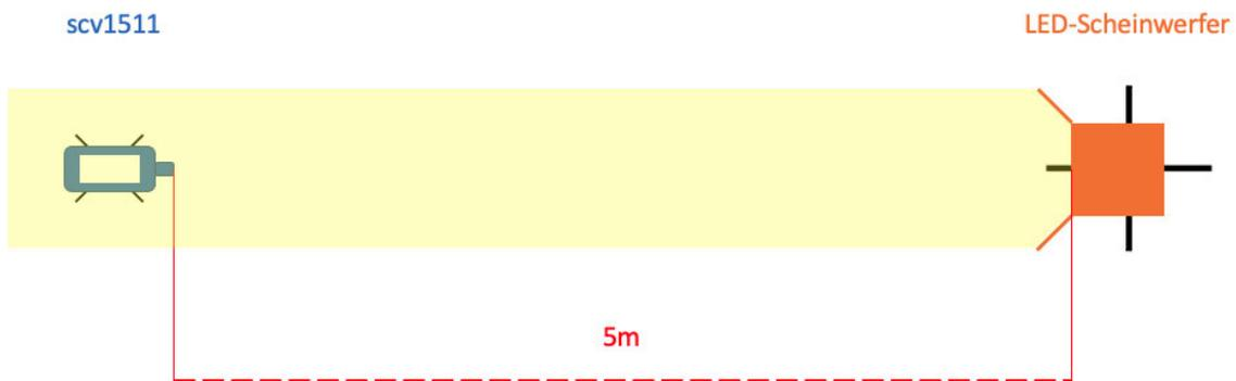
**Abbildung 2.4:** Schematische Darstellung der direkten Messung der LED-Scheinwerfer zur Verifizierung des FixtureCheck-Methode
