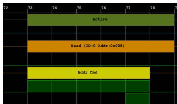
Abb. 7.5. Adressierung des AXI-Subordinate vom SmartConnect bei einer Lesetransaktion
