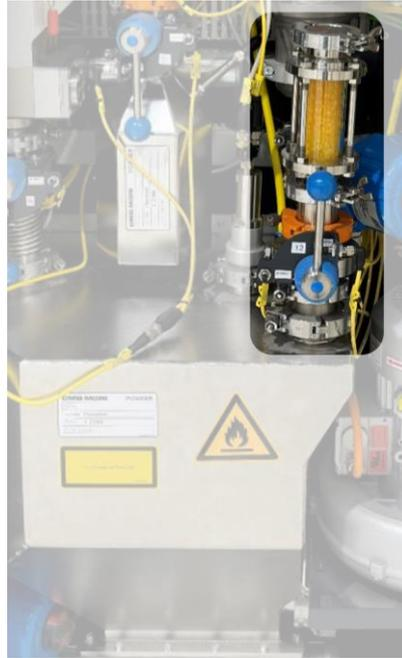
Abbildung 14: Trockenperlen der SLM-Maschine
