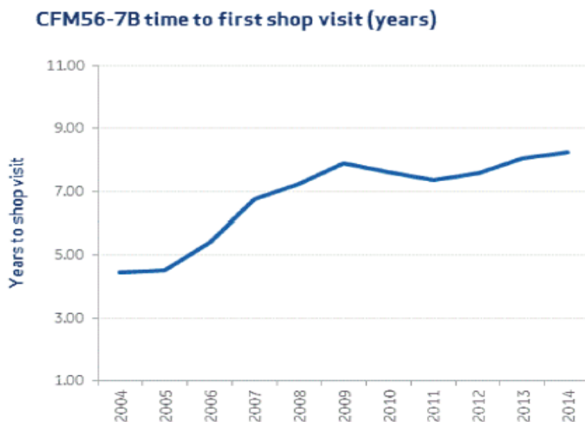
Bild 4.8 Triebwerkswartungsintervalle von 2004 ... 2014 (Aviation Week 2016)
