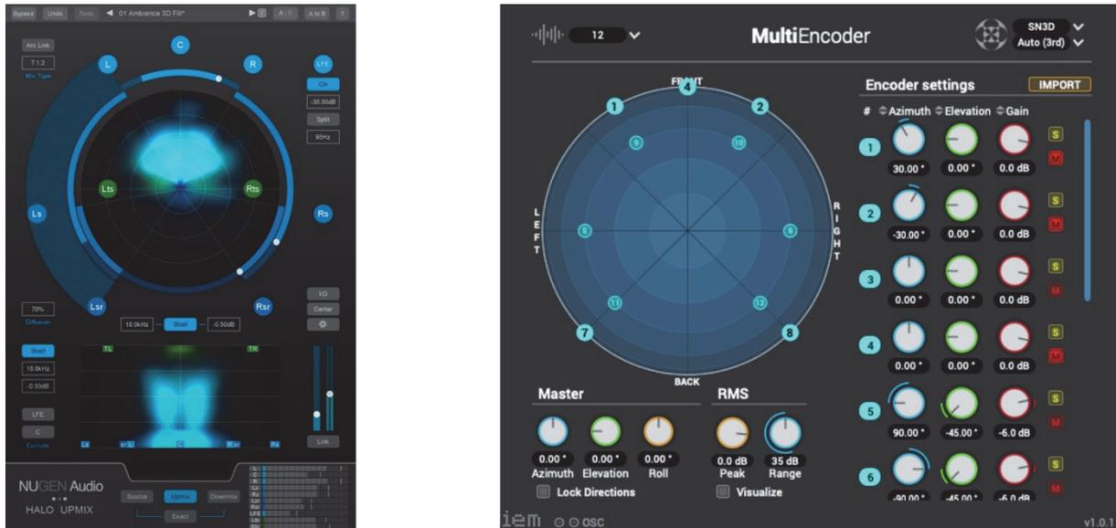
**Abbildung 8.1:** Der Halo-Trick; Halo-Upmix (links) und MultiEncoder (rechts); Kanäle 5, 6, 9, 10, 11 & 12 im MultiEncoder haben  $-45^\circ$  Elevation bei jeweiliger Position; die restlichen Kanäle sind auf „mute“
