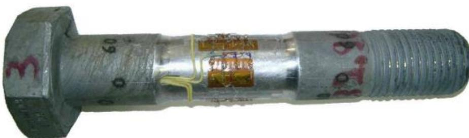
Abbildung 28 - DMS-Schraube M36 HV zur Messung von Schraubkraft, Biege- und Torsionsmoment [Schaumann, P.; Rutkowski, T.]
