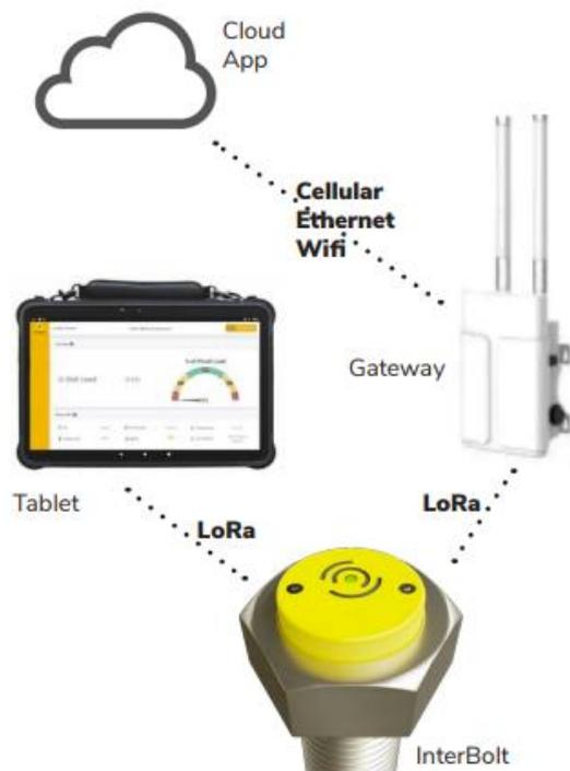
Abbildung 38 - Netzwerkaufbau InterBolt™ [Secure Bolting Systems Ltd.]
