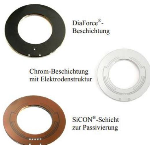
Abbildung 23 - Beschichtungsschritte des Schichtsystems [Von Daacke, S.; Overmeyer, L.]
