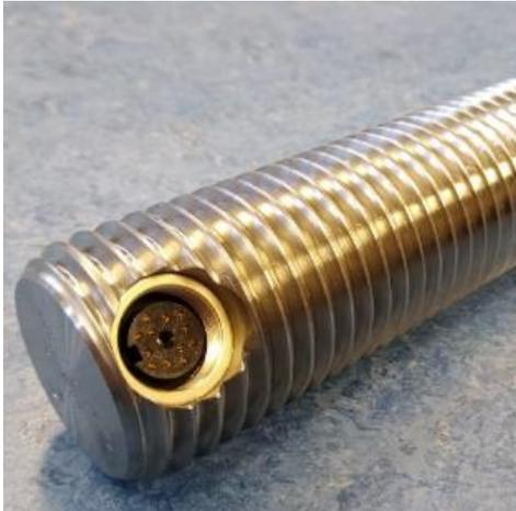
Abbildung 31 - Platzierung des IP-Steckers in der Sensorise SmartScrew [Sensorise GmbH]
