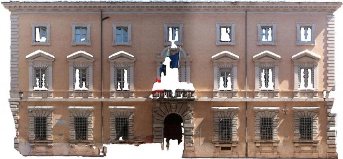
Abbildung 27: Photogrammetrie Modell einer Hausfassade<sup>27</sup>
