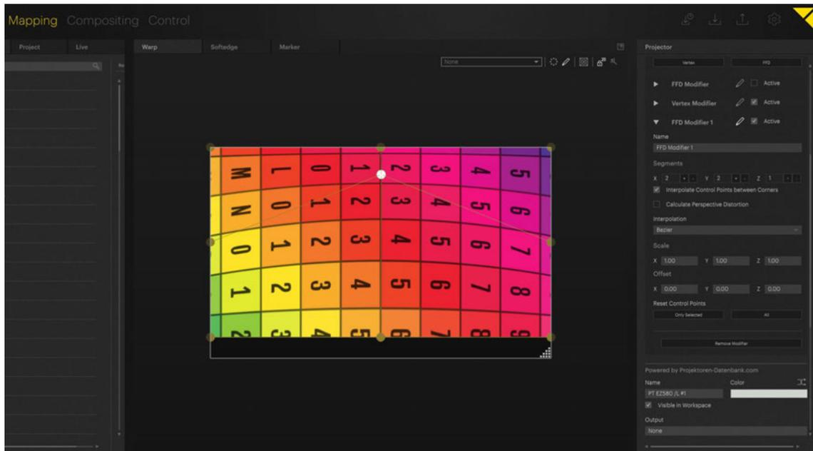
Abbildung 39: Beispiel für Warping in Form einer Bézierkurve in Pixera
