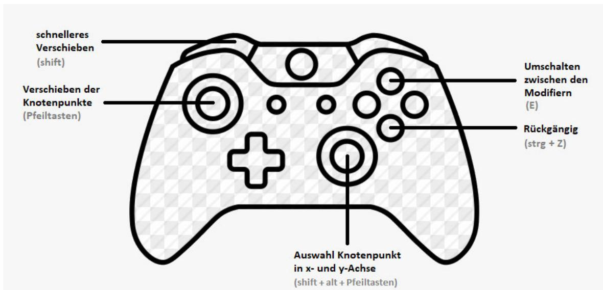
Abbildung 87: Belegung der Taster des Gamepads mit Funktionen zur Einrichtung des Warpings
