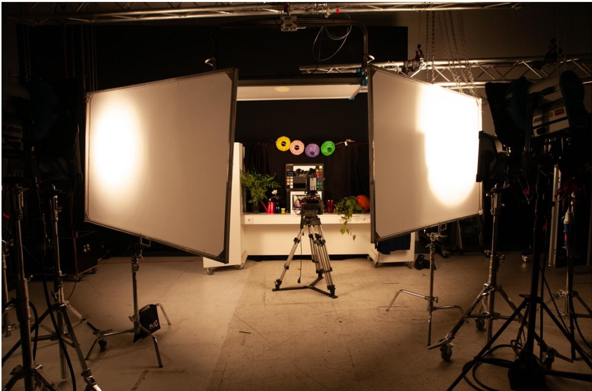
Abbildung 36: Beleuchtetes Testset mit zwei Pollux 5 kW Scheinwerfern
