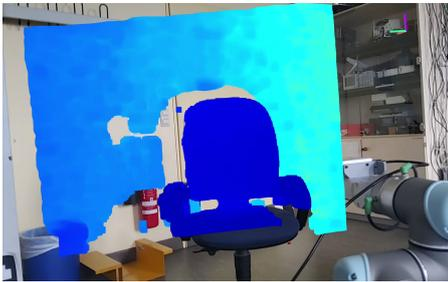
Abbildung 4.17: Point-Cloud-Daten: Frontalansicht auf einen Stuhl, fehlerhaft Darstellung
