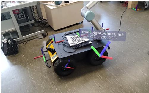
Abbildung 4.7: Darstellung der Husky Fra-Abbildung 4.8: Darstellung der Husky Frames mit Occlusion, rechtes Vorderrad ausgewählt
