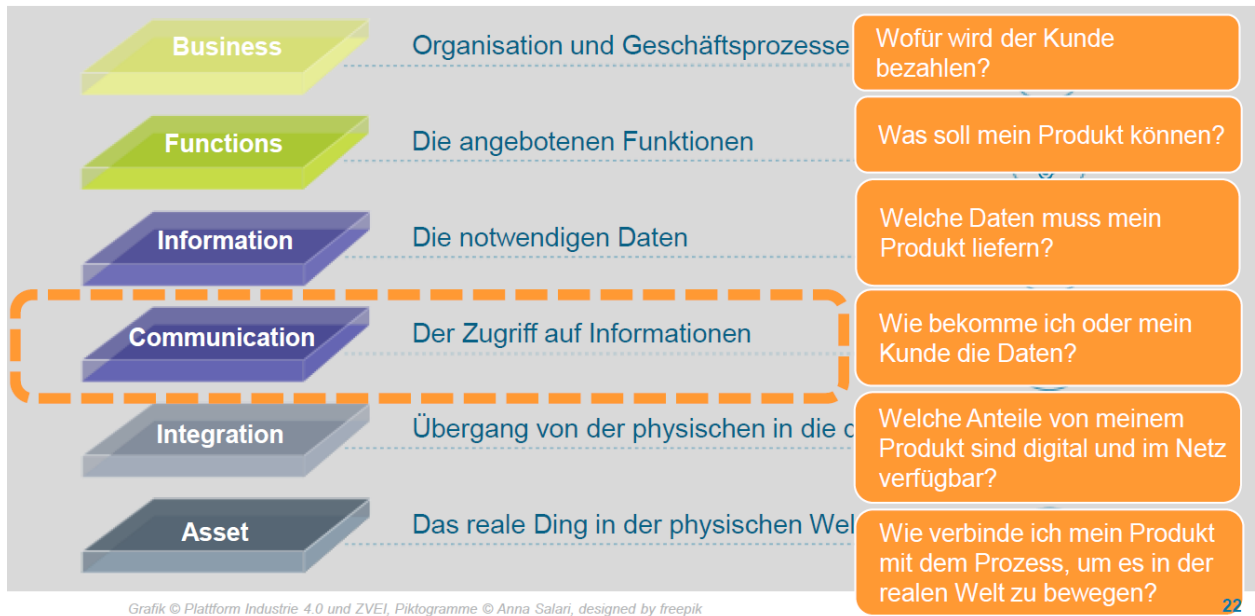
Abbildung 6: RAMI 4.0 Architektur-Achse (Plattform Industrie 4.0, 2022)
