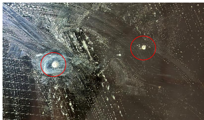
Abbildung 9: Druckstellen durch den Federkürner (Eigene Darstellung)
