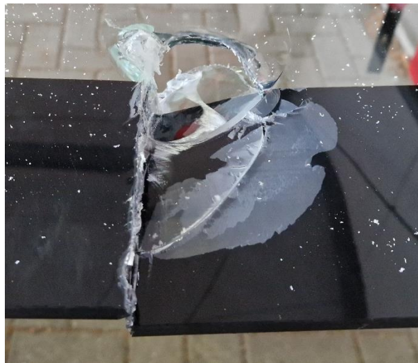
Abbildung 11: Zweiter Schnitt der Rettungsschere durch das PC (Eigene Darstellung)
