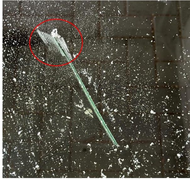
Abbildung 13: Ca. 25 Zentimeter langer Schnitt durch die Säbelsäge (Eigene Darstellung)
