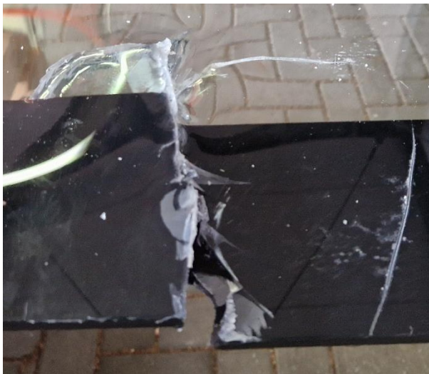
Abbildung 12: Erster Schnitt der Rettungsschere durch das PC (Eigene Darstellung)
