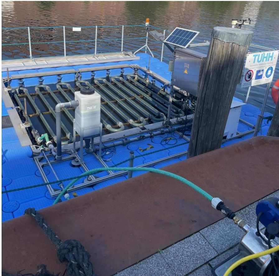
Abbildung 9: Der schwimmende Photobioreaktor wird zum Animpfen über eine Pumpe über das Ernteventil mit dem Vorlagebehälter verbunden
