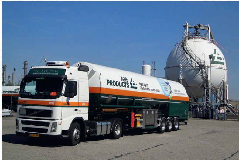
Abbildung 10: Transport von flüssigem Wasserstoff mittels eines LKW-Trailers
