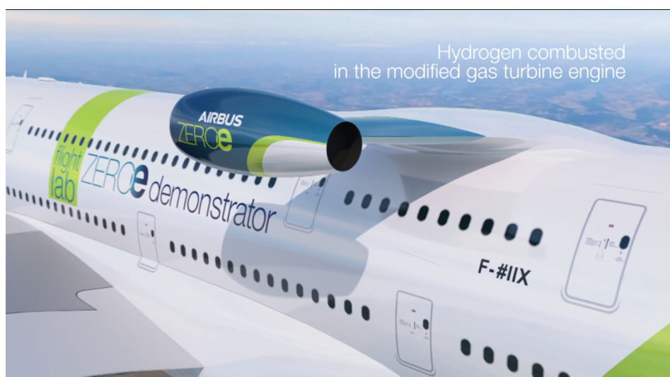
Abbildung 18: Zusätzliche Gasturbine am Airbus A380 [35]
