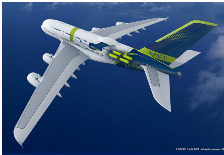
Abbildung 19: Unterbringung von vier Wasserstofftanks [38]
