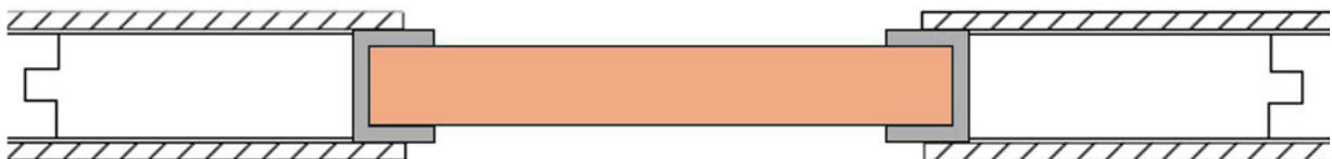
Abbildung 55: Querschnitt der vorgeschlagenen Konstruktion mit U-Profil (grau) zur Fixierung des Sperrbretts (orange) (Lugon u. a. 2009, bearbeitet)
