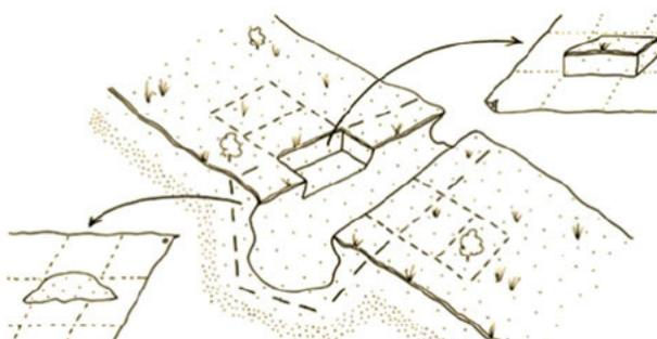
Abbildung 57: Grabenböschung, die vor Dammbau freigelegt werden muss (Lugon u. a. 2009)
