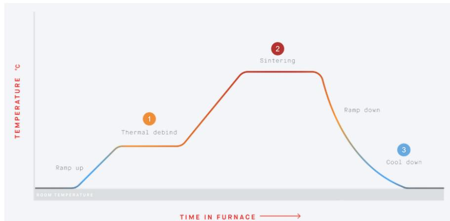
Abbildung 2.2: Zeit-Temperatur-Verlauf für einen Entbinder-Sinter-Process [17]
