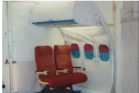
BILD 3. Ergonomisches Experimental Mock up als Grundlage für das Designkonzept
