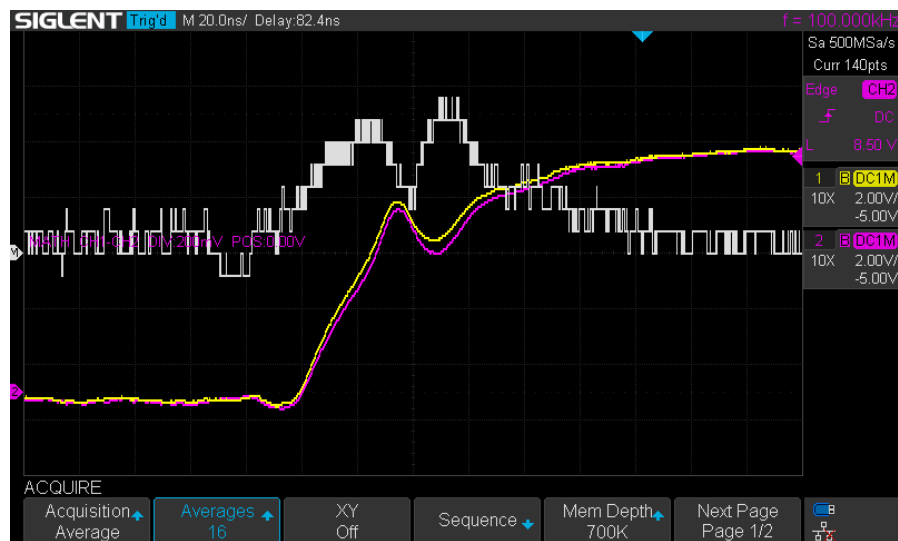
Abbildung 10.1: Gate Strom I_{gate} = (U_{r,gate} - U_{gate})/0.5\Omega
